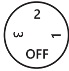
Posizione OFF- Ventilatore spento
