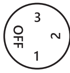
Position 1- Vitesse de ventilateur élevée
