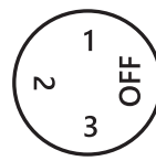
Position 3- Low fan speed
