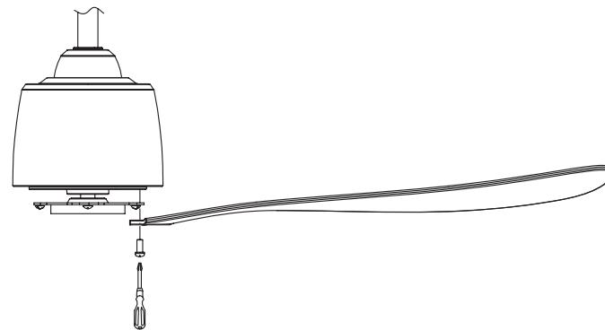
**Achtung!** Die im Lieferumfang des Ventilators enthaltenen Flügel entsprechen einem passenden Satz. Mischen Sie sie nicht mit Flügeln eines anderen Ventilators.
