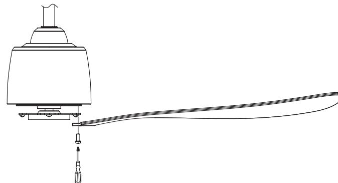
**¡Atención!** Las aspas que se entregan con el ventilador son idénticas. No las mezcle con aspas de otro ventilador.
